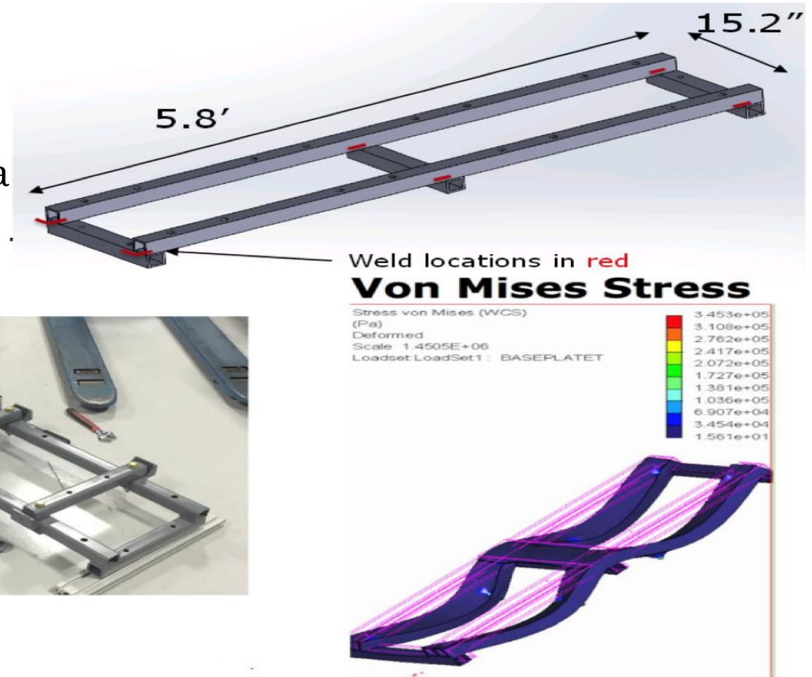
Fig. 6. Base Frame Von Mises Stress
